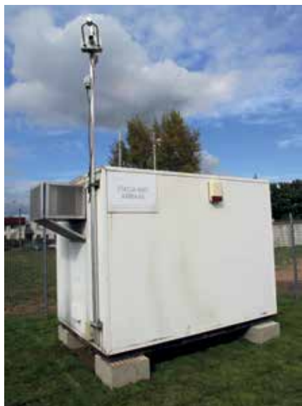
Stacja kontenerowa do pomiaru jakości powietrza
