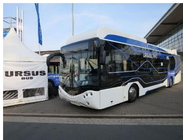
Rys. 2.5 Autobus na ogniwa wodorowe polskiej konstrukcji
